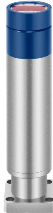
PK 系列开关量压力变送器主要由测压元件传感器（也称作压力传感器）、测量电路和过程连接件三部分组成。它能够将测压元件传感器感受到的气体、液体等物理压力参数转变成标准的电压或者电流模拟信号，同时通过运算处理的信号来控制 PNP 或者 NPN 开关输出，对控制系统压力进行测控，以供给指示报警仪、记录仪、调节器等二次仪表进行测量、指示和过程调节。开关量可在零点和满度之间任意设定。同时，高纯半导体压力变送器的过程连接都经过 BA 或者 EP 级处理，达到半导体行业内的使用要求。
