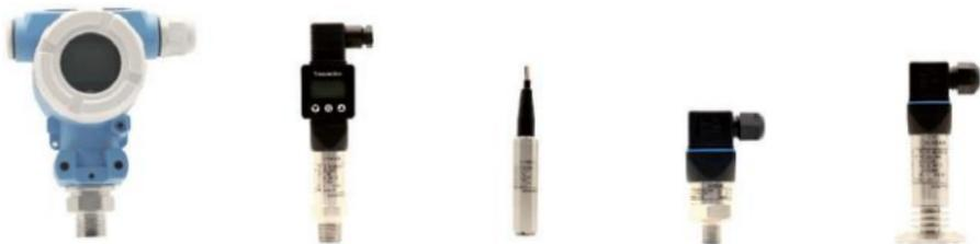
PK系列变送器主要由测压元件传感器(也称作压力传感器)、测量电路和过程连接件三部分组成。它可将测压元件传感器感受到的气体、液体等物理压力参数转变成标准的电信号(如4...20mA DC等),以供给指示报警仪、记录仪、调节器等二次仪表进行测量、指示和过程调节。
