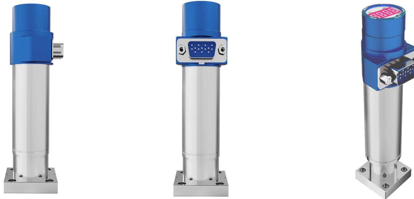
PK 系列开关量压力变送器主要由测压元件传感器（也称作压力传感器）、测量电路和过程连接件三部分组成。它能将测压元件感受到的气体、液体等物理压力参数转变成标准的电压或者电流模拟信号，同时通过运算处理的信号来控制 NPN 开关输出，对控制系统压力进行测控，以供给指示报警仪、记录仪、调节器等二次仪表进行测量、指示和过程调节。开关量可在零点和满度之间任意设定。同时，高纯半导体压力变送器的过程连接都经过 BA 或者 EP 级处理，达到半导体行业内的使用要求。
